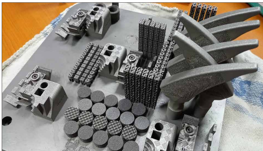
Komponenty vzniklé kovovým 3D tiskem na platformách před tepelným zpracováním
